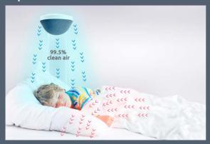
Il flusso d'aria laminare a temperatura controllata (TLA) filtra l'aria nella zona di respirazione e rimuove il 99,5% di tutti gli allergeni e le particelle irritanti più grandi di 0,5 µm.
